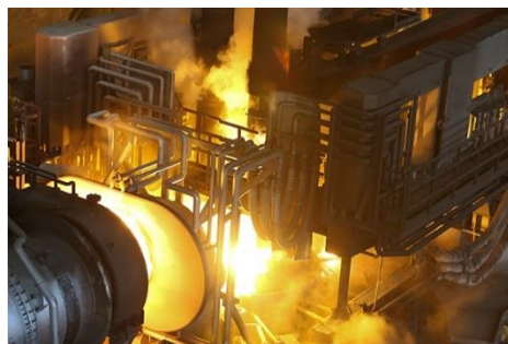
大同特殊鋼(株)知HPより抜粋 150tアーク炉のようす
